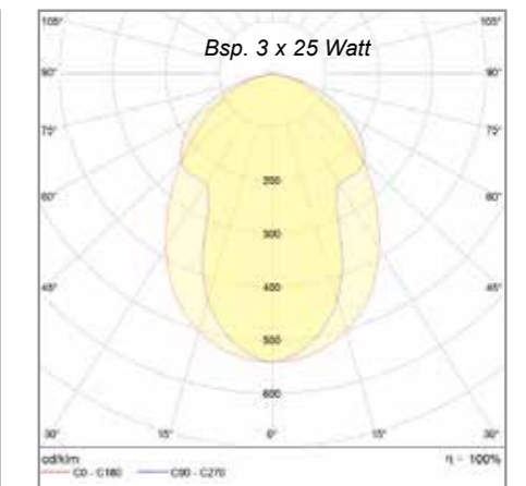
Lichtverteilungskurve des Umrüstsatzes upgrademaxLED.
